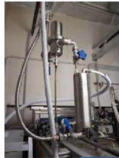
Figura 2 – Sistema refrigerazione per campioni
